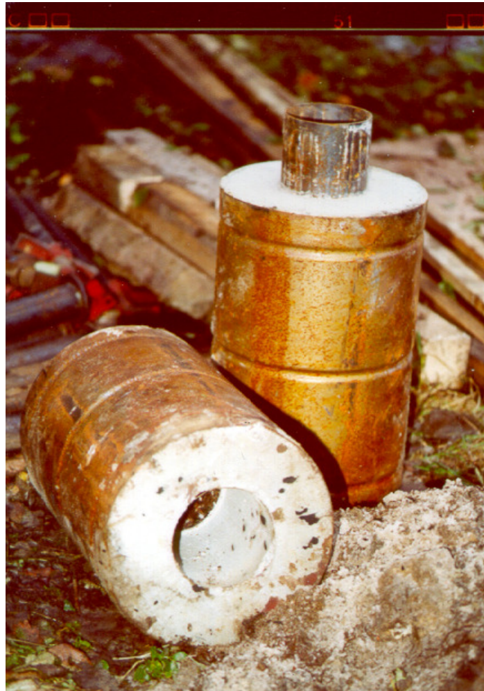
Bild 3: Pfahlsegmente mit Nut und Feder
